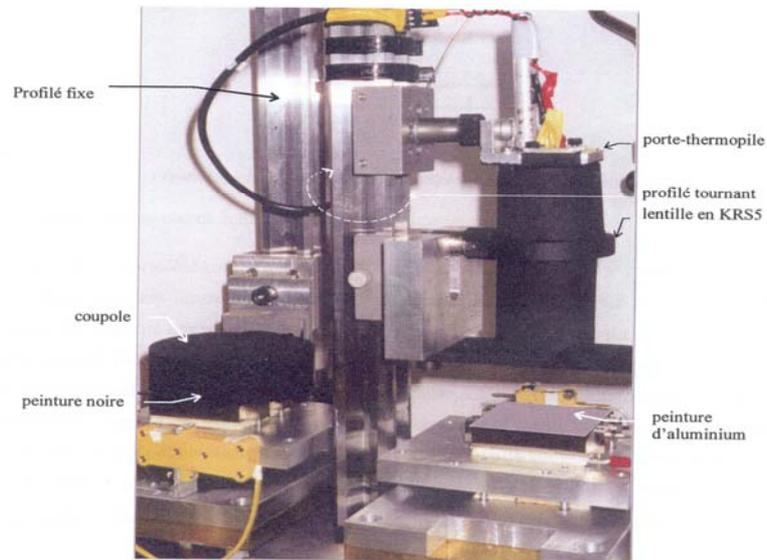
**Figure 19-a:** Montage utilisé pour la mesure de l'émissivité de la peinture d'Aluminium
