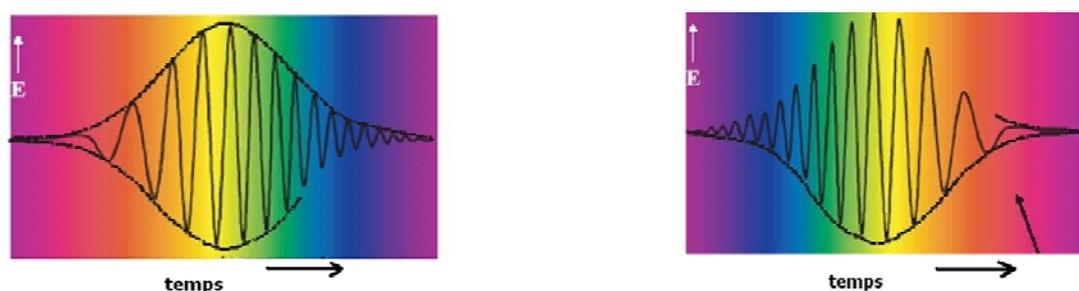
Figure 1.5.a: Impulsion à dispersion normale. Figure 1.5.b: Impulsion à dispersion anormale.
