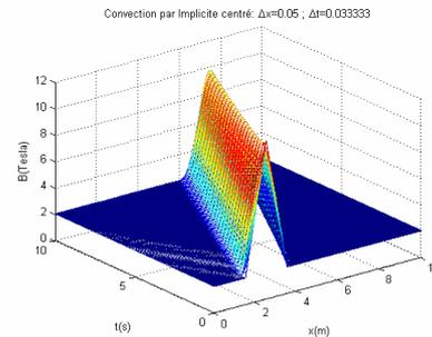
Fig. 1. Evolution du champ magnétique par convection
