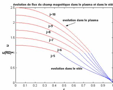
Fig. 5. Comportement de flux de champ magnétique dans le plasma et dans le vide
