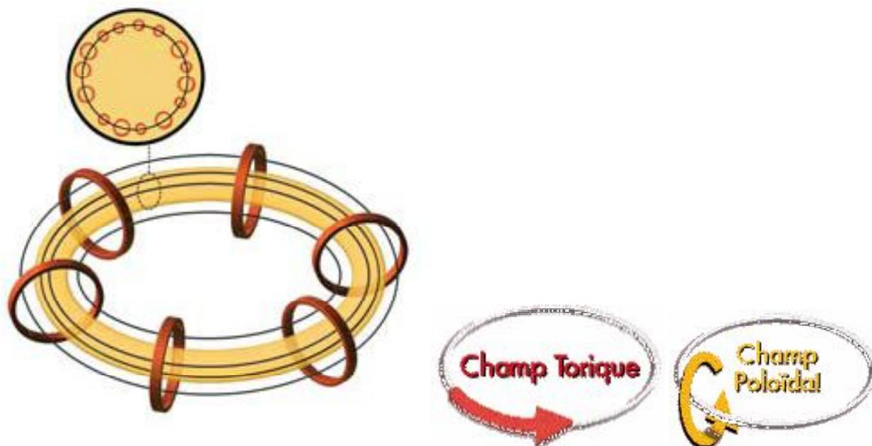
Figure 1-12: Les lignes de champs toroïdales et poloïdales
